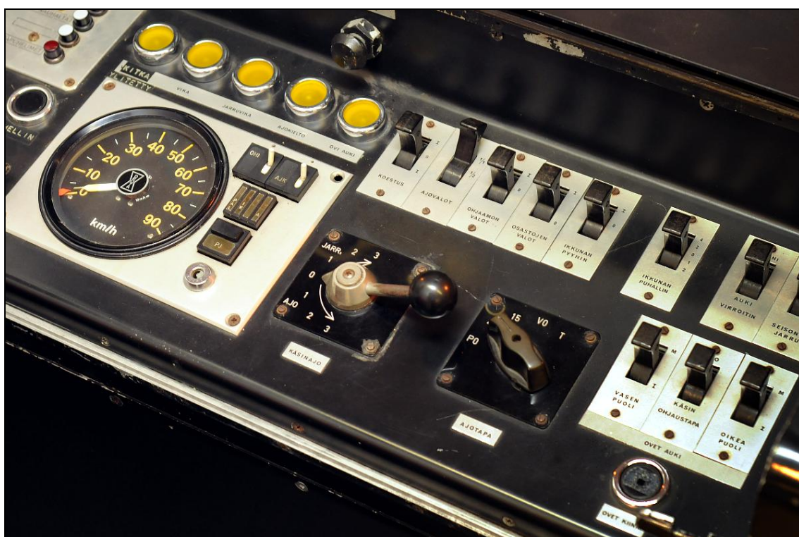
Kuva 4. Koejunan ohjauspöydän kytkimiä. Lähtöajatuksena ollut automaattiajo näkyy monessa asiassa: ohjauspöytä on suunniteltu kannella peitettäväksi, jolloin myös junavalvojan ohjauspaikalla voisi istua matkustajia. Nopeusmittarin ulkokehällä näkyy LZB-kulunvalvonnan oranssi neula, joka osoitti hetkellistä suurinta sallittua nopeutta. Nopeusmittarin ohessa on pieni valkoinen keinu-kytkin "OHI", jolla juna voitiin käskä ajamaan automaattiajossa aseman ohi pysähtymättä. Sen vieressä olevalla kytkimellä "AJK" voitiin valita liukkaalla kelillä "alempi jarrutuskäyrä", eli pienempi hidastuvuus. Kuvan keskivaiheilla oleva vetoa ja jarrutusta säätelevä ajokahva on nimetty kyltillä "käsinajo". Oikeassa reunassa olevissa ovien ohjauskytkimissä on valittavissa ohjaustavaksi joko "käsin" tai "ATO" (Automatic Train Operation). Tiedot Metrotoimiston (1974a) koeradalla toimintaohjeesta, kuva metrovarikolla museoituna olevasta koejunavaunun M3 keulasta (Hietaranta 2013a).
