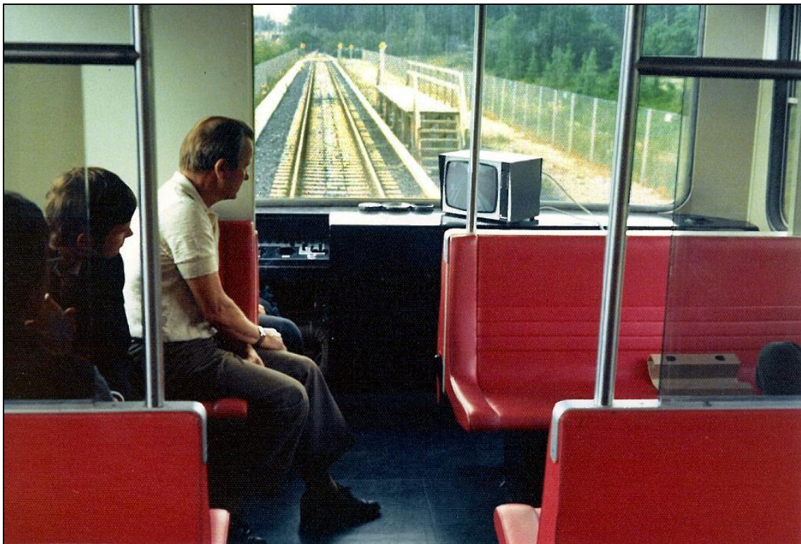
Kuva 5. Koejuna metron koeradalla Herttoniemessä 1970-luvulla. Kiskojen välissä erottuvat LZB-kulunvalvonnan linjajohdot. Automaattiajoon suunnitelluissa koejunissa ei ollut varsinaista ohjaamoa, vaan ainoastaan ohjauspaikka. Hallintalaitteet oli peitettävissä kannella ja tuulilasin edustalla oli läppäistuimet. Koeajojen yhteydessä kuitenkin raporttoitiin, että kuljettajan (junavalvojan) paikka oli liian vetoisa ja penkin puuttuvien säätömahdollisuuksien takia ergonomia oli huonoa (Metrotoimikunta 1975). Kuva HKL-Metroliikenteen arkistosta.
